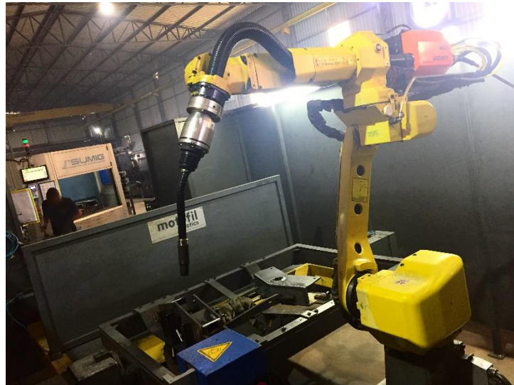
Figura 2 - Célula de solda Robótica
