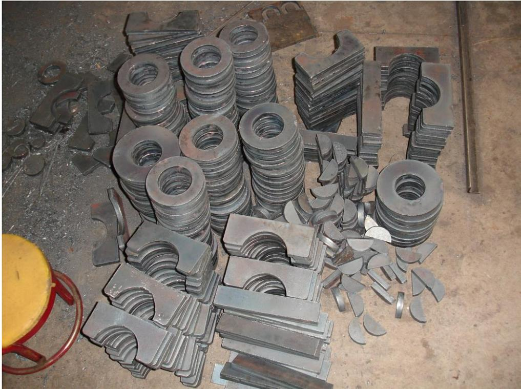
**Figura 10 - Modelo de peças variadas produzidas pelo setor de Oxicorte.**
