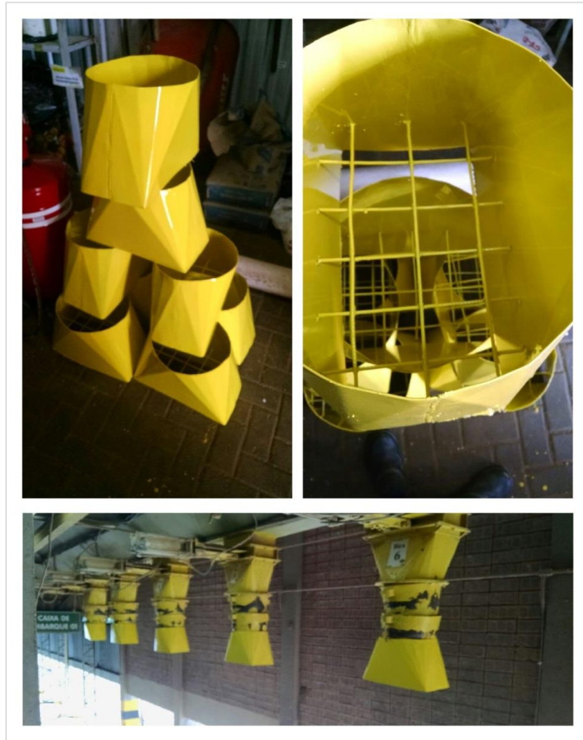
Figura 15: Bocais confeccionados pelo setor de manutenção industrial
