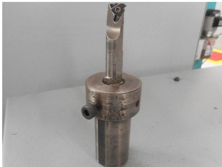
**Figura 7: Ferramenta de usinagem com bucha externa**
