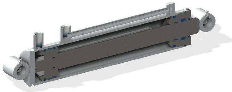
**Figura 2: Vista 3D interna de um cilindro hidráulico, através de corte transversal**
