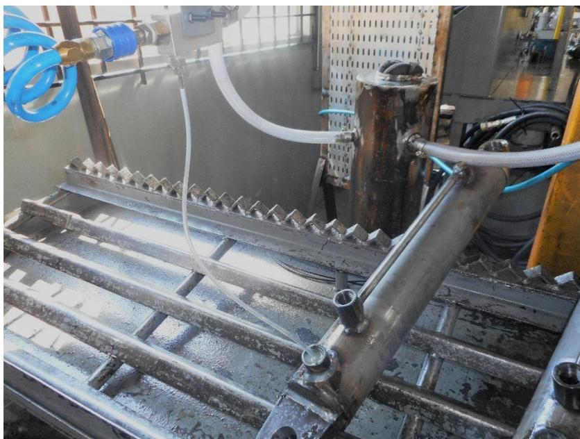
**Figura 17: Bancada de esgotamento de óleo**
