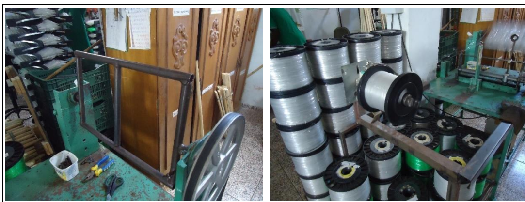
Figura 15 - Procedimento de desenrolar fio Fonte: Autor, 2016
