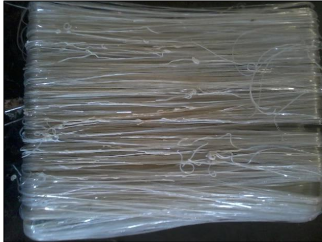
Figura 27 - Exemplo de fios que excederam no processo de cristalização Fonte: Autor, 2016
