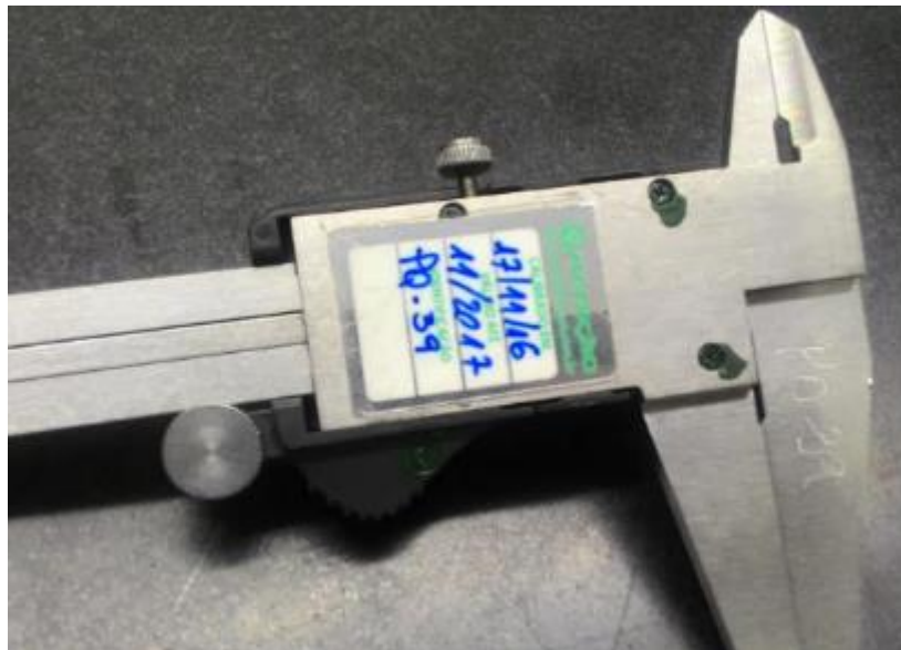
Figura 33 - Identificação da calibração do paquímetro digital 39
