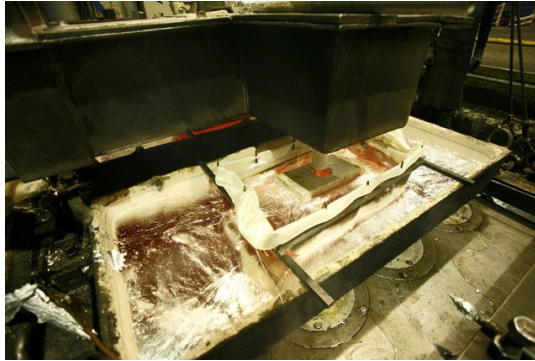
Figura 4-5: Vazamento de Tarugos de 4 polegadas Fonte: Autor, 2016.
