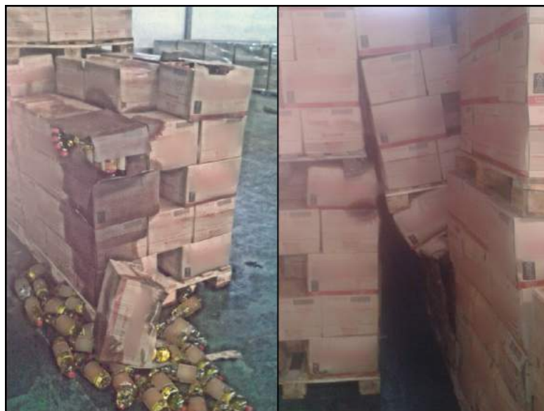
Figura 20 - Problemas de resistência de carga devido às aberturas
