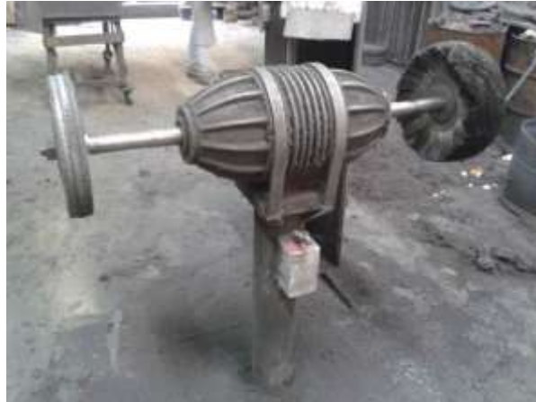
Figura 27 – Partes móveis da polidora sem proteção. Fonte: Autor, 2016.
