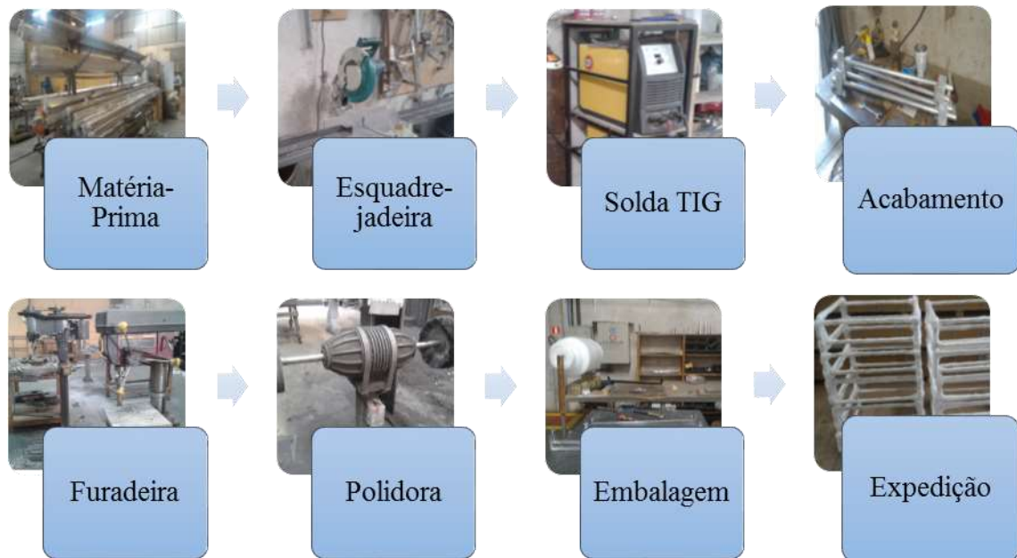
Figura 11 – Sequenciamento de processos para a produção de peças de alumínio. Fonte: Autor, 2016.
