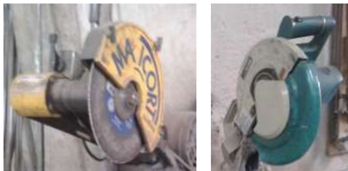
Figura 26 – Policorte sem proteção (esq.) e esquadrejadeira com proteção para lâmina (dir.) Fonte: Autor, 2016
