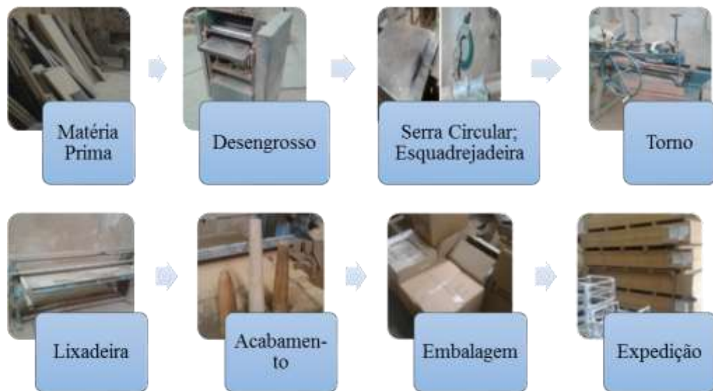
Figura 14 – Sequenciamento de processos para a produção de pés de madeira. Fonte: Autor, 2016.
