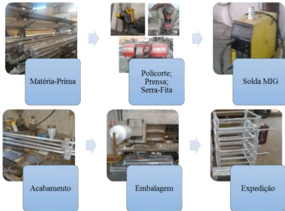
Figura 12 – Sequenciamento de processos para a produção de peças de ferro. Fonte: Autor, 2016.
