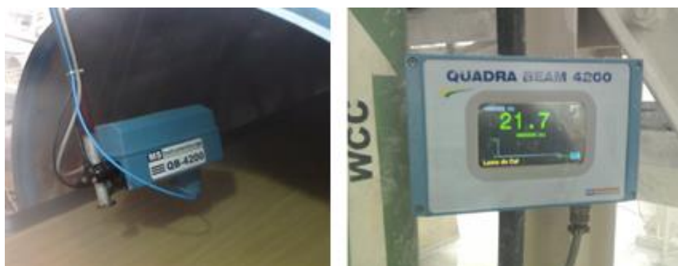
Figura 4.5 - Analisador de umidade online por infravermelho e seu visor de verificação
