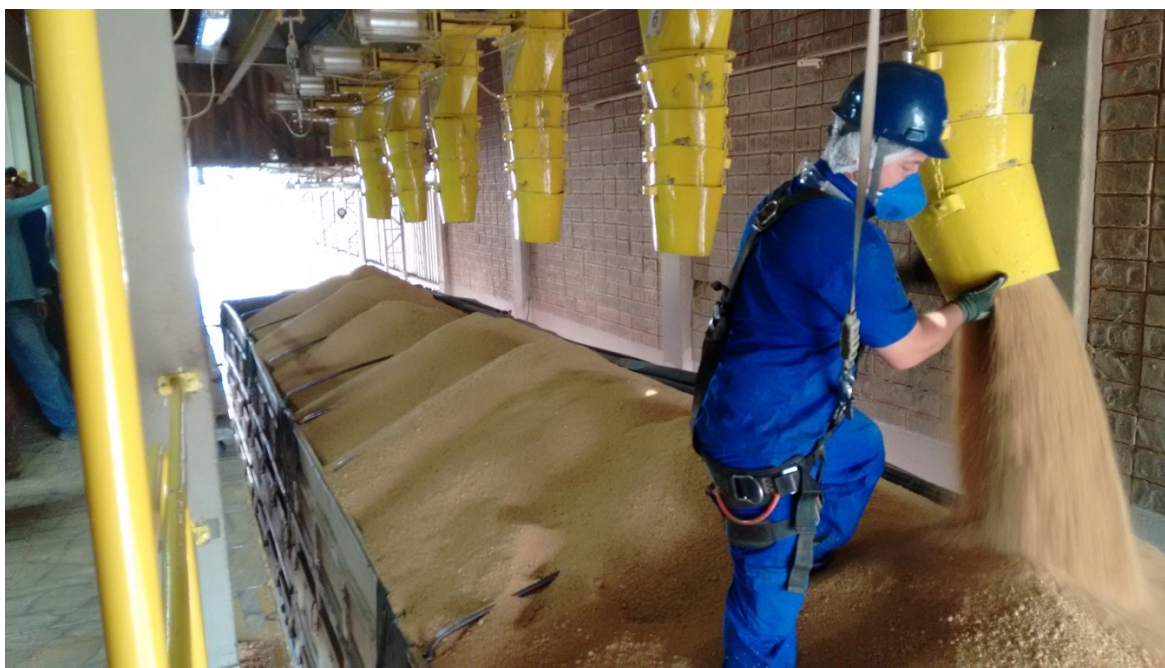
Figura 9: Farelo sendo embarcado nos caminhões
