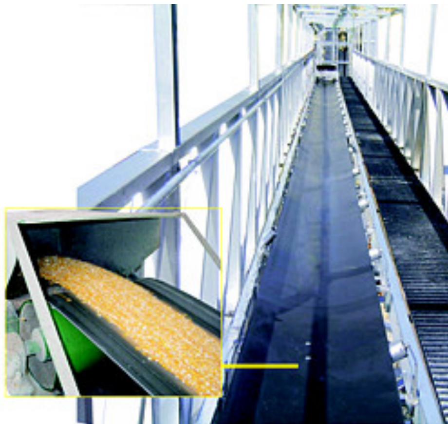
Figura 8: Fita transportadora de farelo
