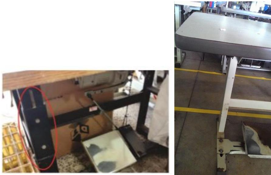
**Figura 17: Mesa com mecanismo de regulagem de altura (esquerda) e mesa sem mecanismo de regulagem de altura (direita)**
