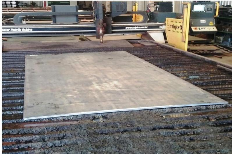
Figura 13: Posição da Chapa na Mesa de Corte
