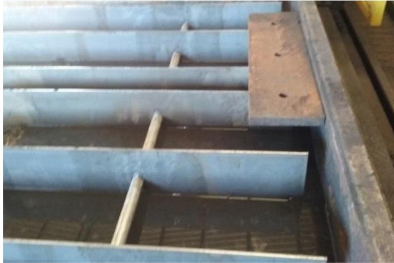
**Figura 17: Batente modelo A fixado a mesa**
