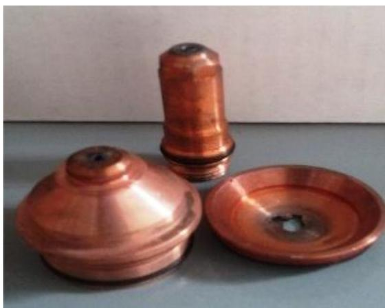
**Figura 20: Conjunto Consumível (Bico, Eletrodo e Capa)**
