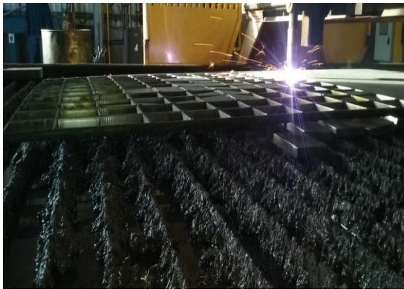
Figura 8: Setor de Corte a Plasma CNC em Operação
