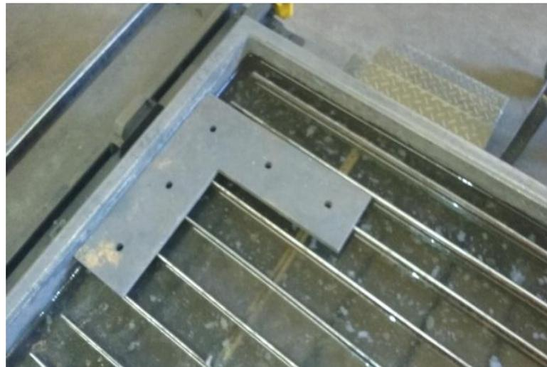
**Figura 18: Batente Modelo B fixado a mesa**
